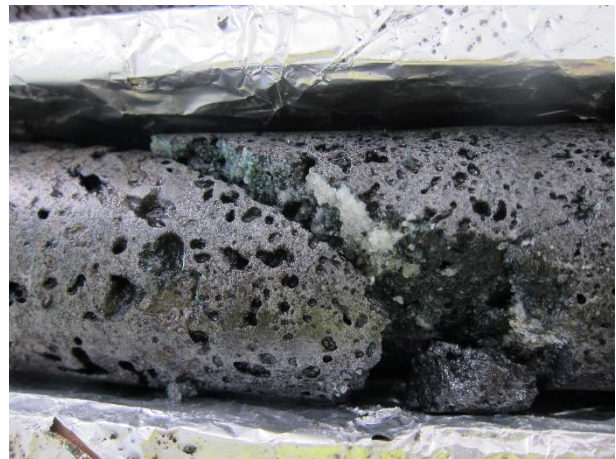
Borkjarni af Hellisheiði sem sýnir hvernig koltvíoxíði hefur verið breytt í steindina kalsít
